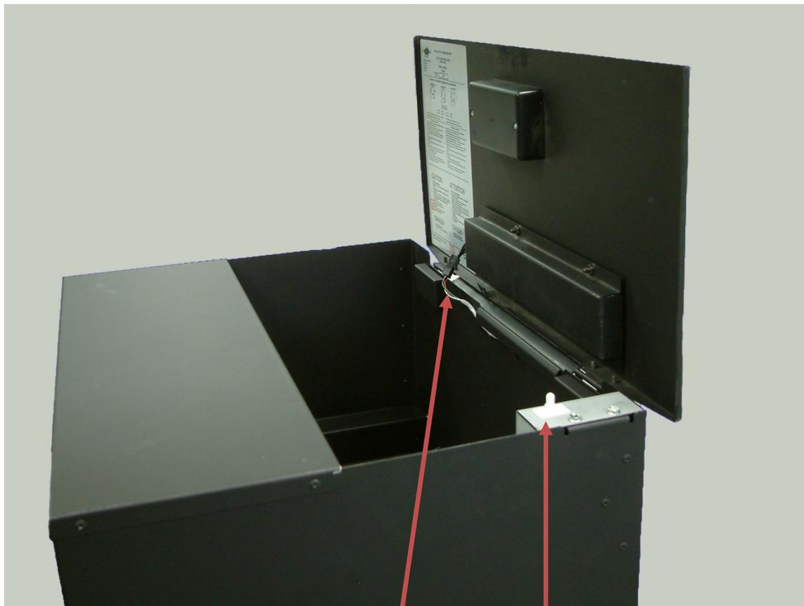
Reconnecter le câble de l'écran tactile et le câble de l'interrupteur de trémie.
