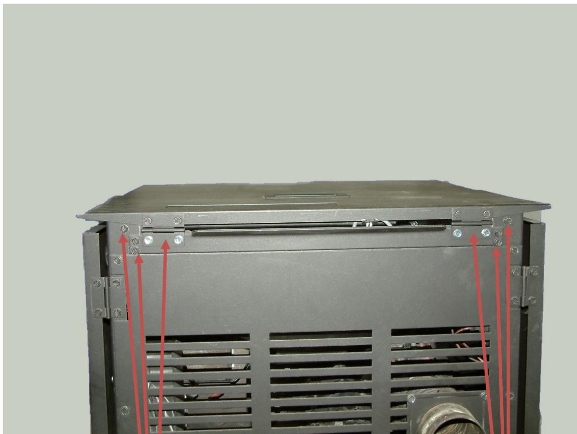
Enlever les 4 vis inférieures des pentures du couvercle de trémie, les 4 vis du support de butoir ainsi que les vis de coin.
