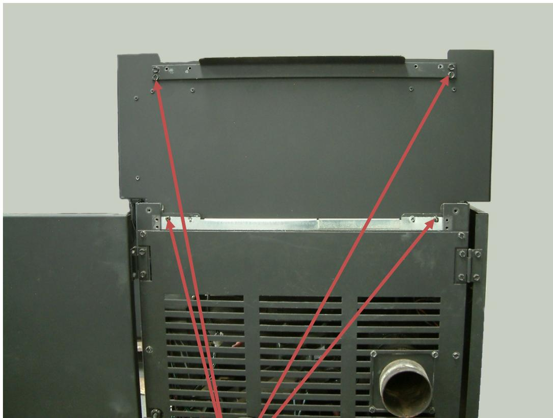
Replacer le couvercle de trémie et fixer les pentures à l'aide des vis gardées précédemment.
