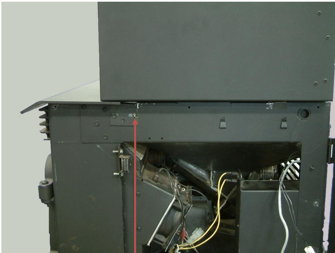
Insérer l'extension de trémie dans la trémie et la fixer de chaque coté à l'aide de vis auto-perçantes par les trous arrières du support de dessus avant.
