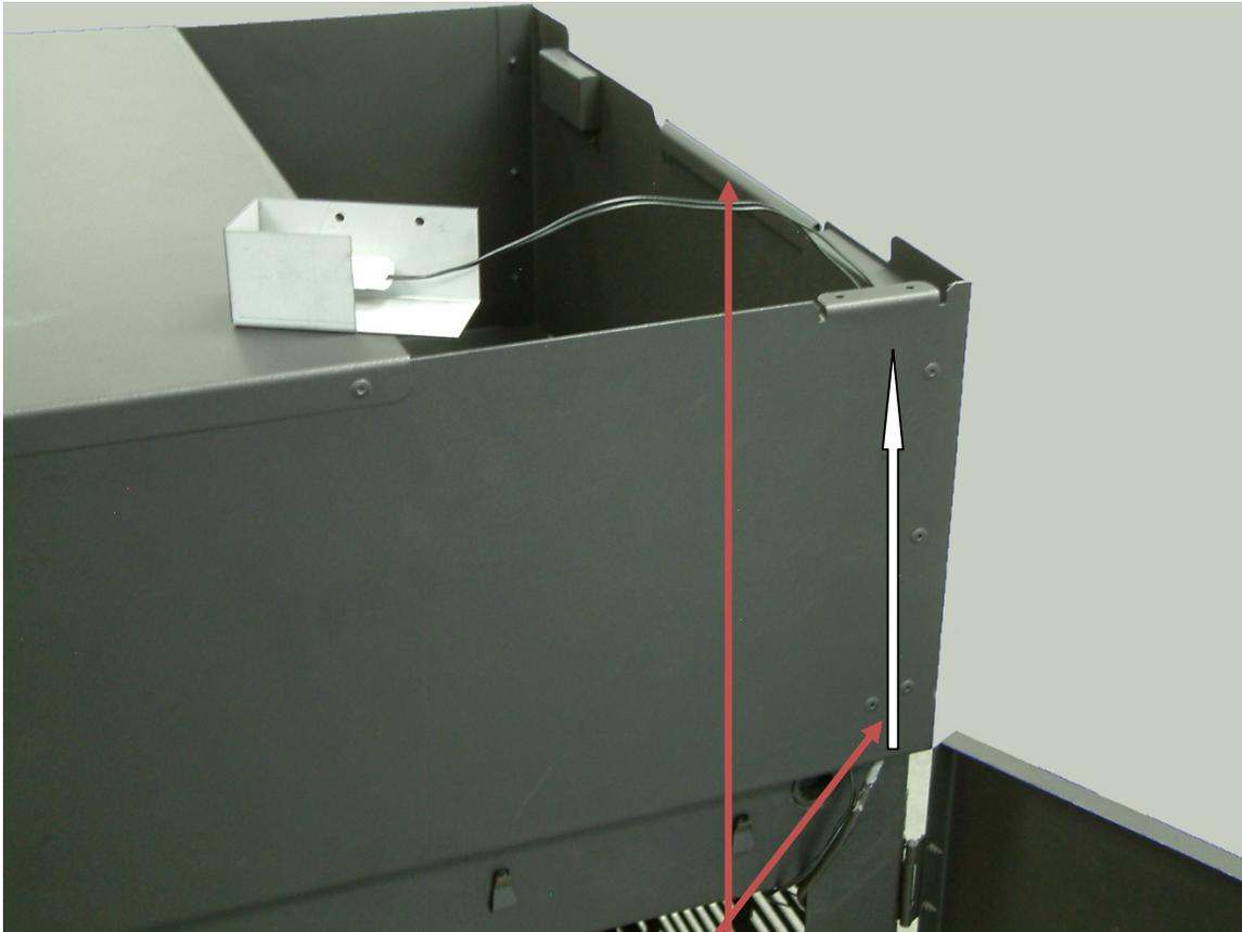
Passer les fils de l'interrupteur de trémie et de l'écran tactile dans la canalisation verticale à l'intérieur de l'extension de trémie.
