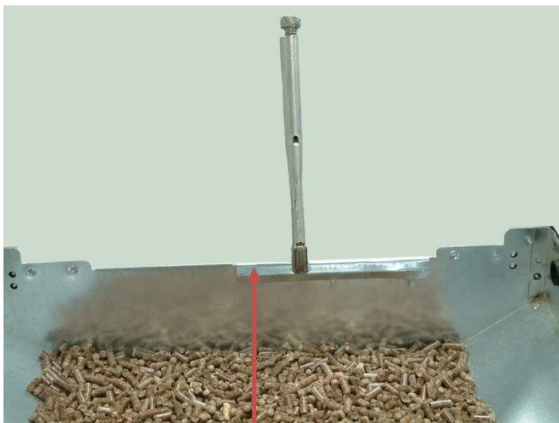
A l'aide de pinces à étau, replier le protecteur de filage et le support de l'interrupteur de la trémie au maximum contre les parois de la trémie.
