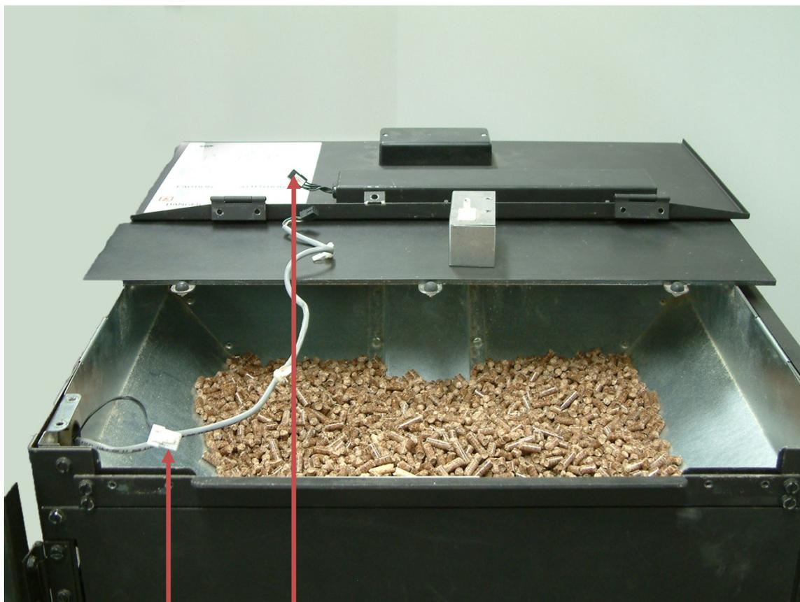
Déconnecter les fils de l'écran tactile et de l'interrupteur de trémie et sortir les fils du passe-fil.
