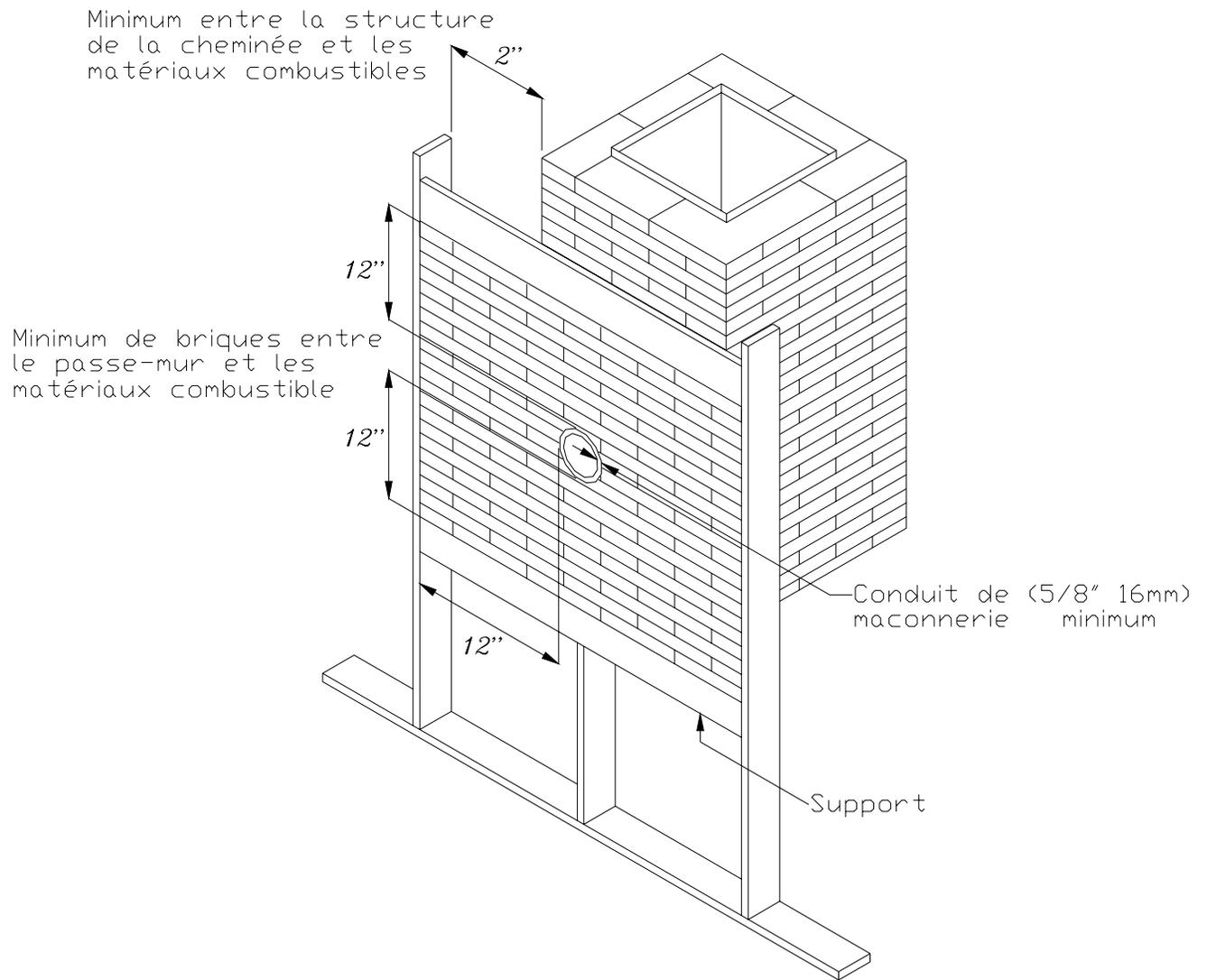
**FIGURE 2.2.2 (C) Passe-mur de briques**
