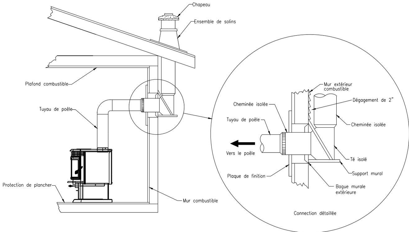
**FIGURE 2.2.1 (A) Installation typique à travers le mur**
