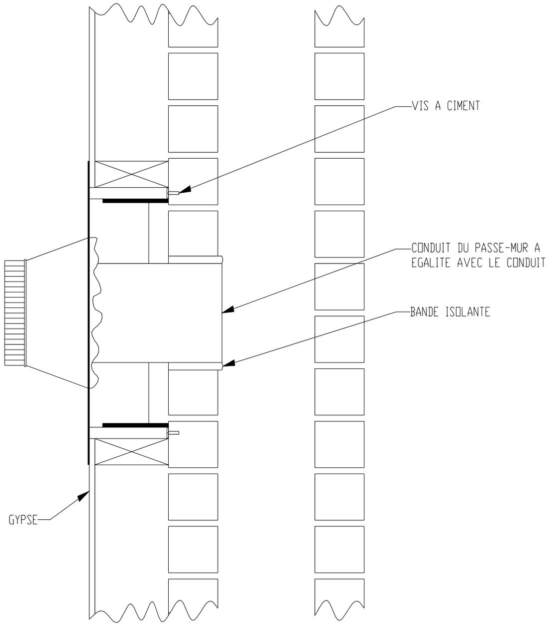
**FIGURE 2.2.2 (B) Passe-mur préfabriqué**
