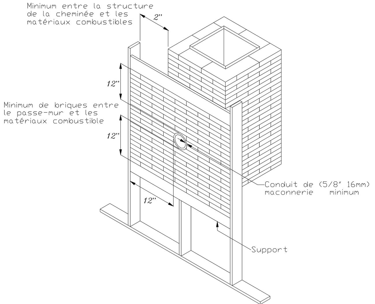
**FIGURE 2.2.2 (C) Passe-mur de briques**
