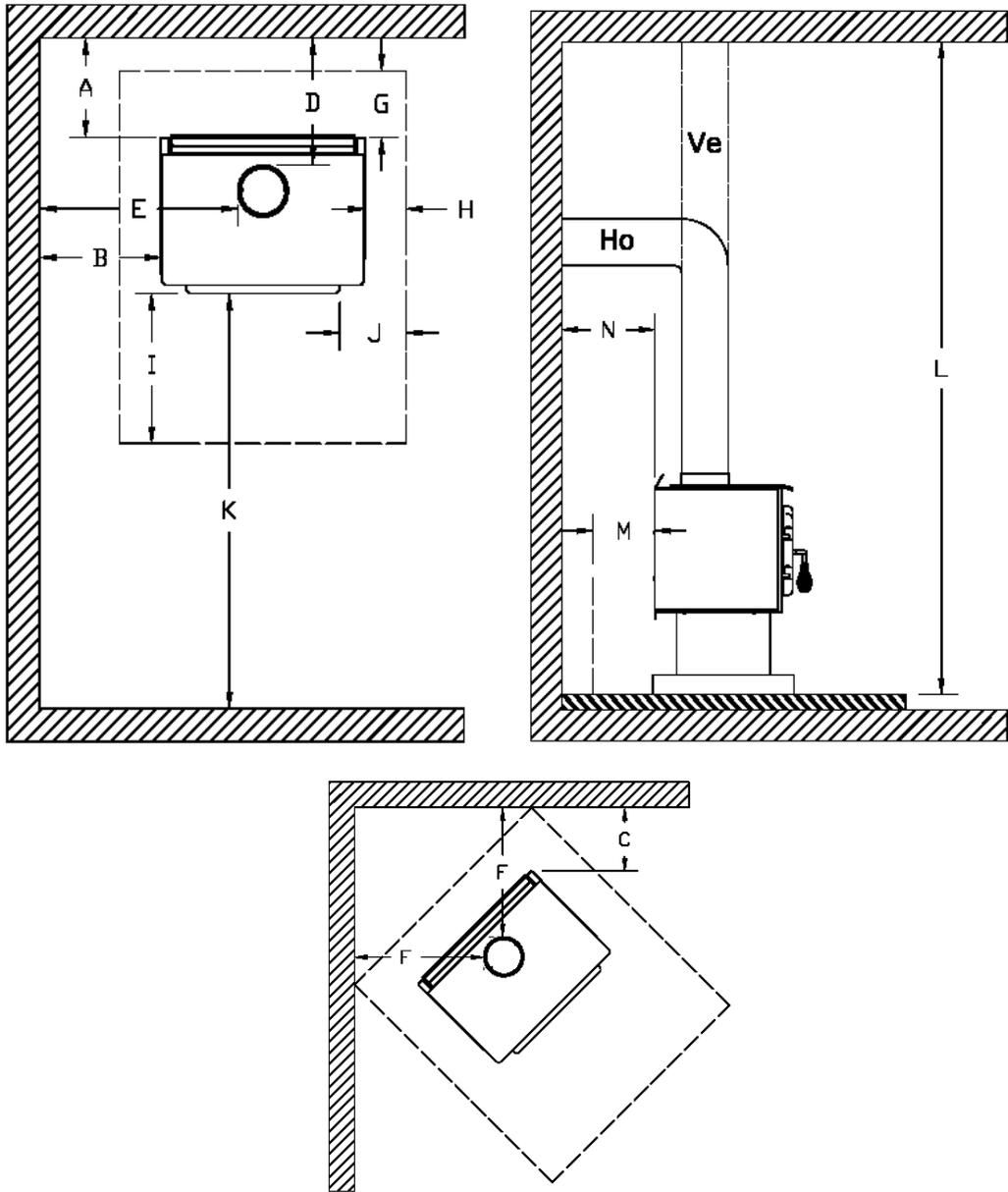
**FIGURE 1.3** - Dégagements aux matériaux combustibles et protection du plancher
