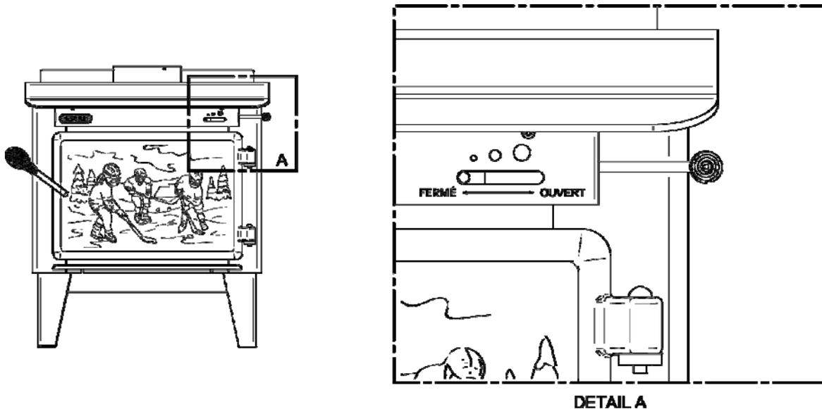
FIGURE 3.1 Le contrôle d'admission d'air
