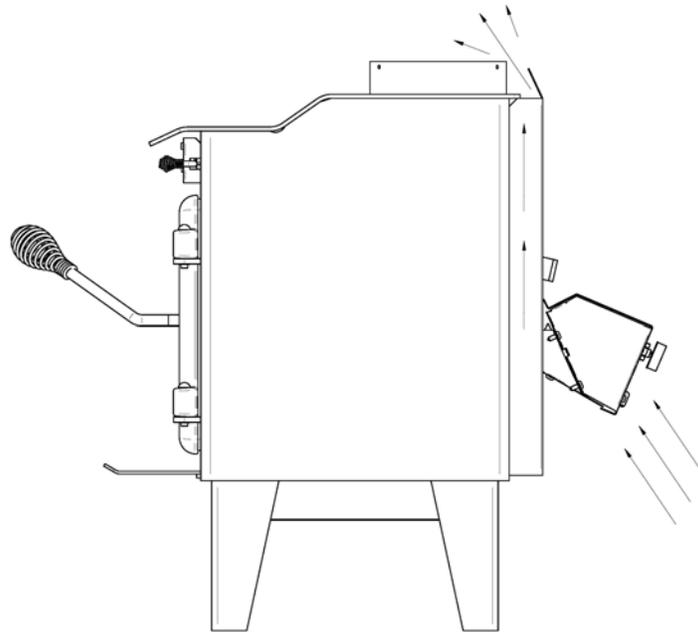
**FIGURE 2.5** Les avantages d'un souffleur (ventilateur)
