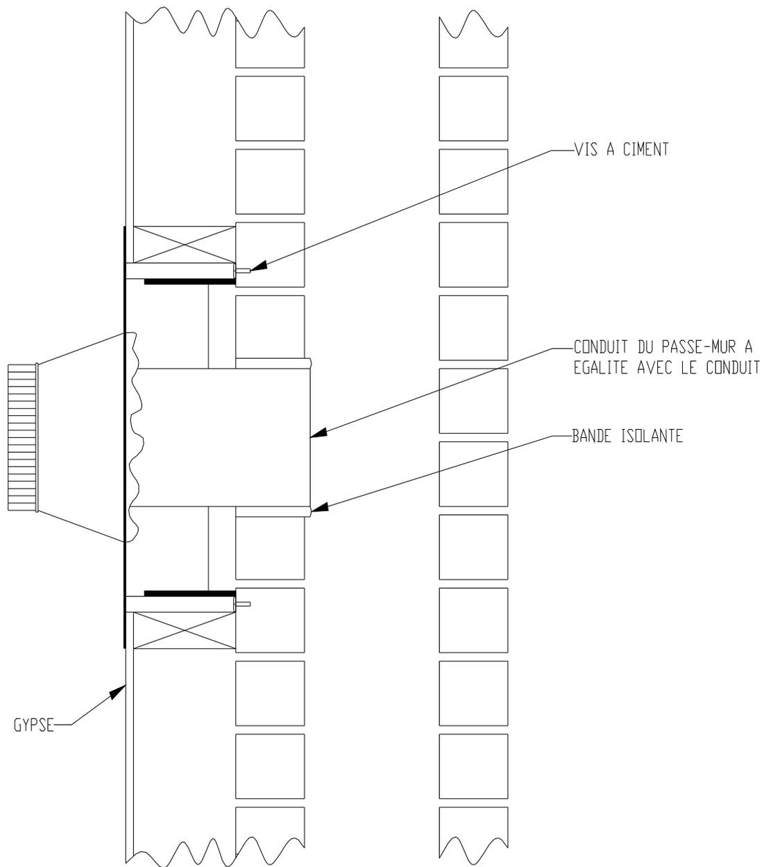
**FIGURE 2.2.2 (B) Passe-mur préfabriqué**
