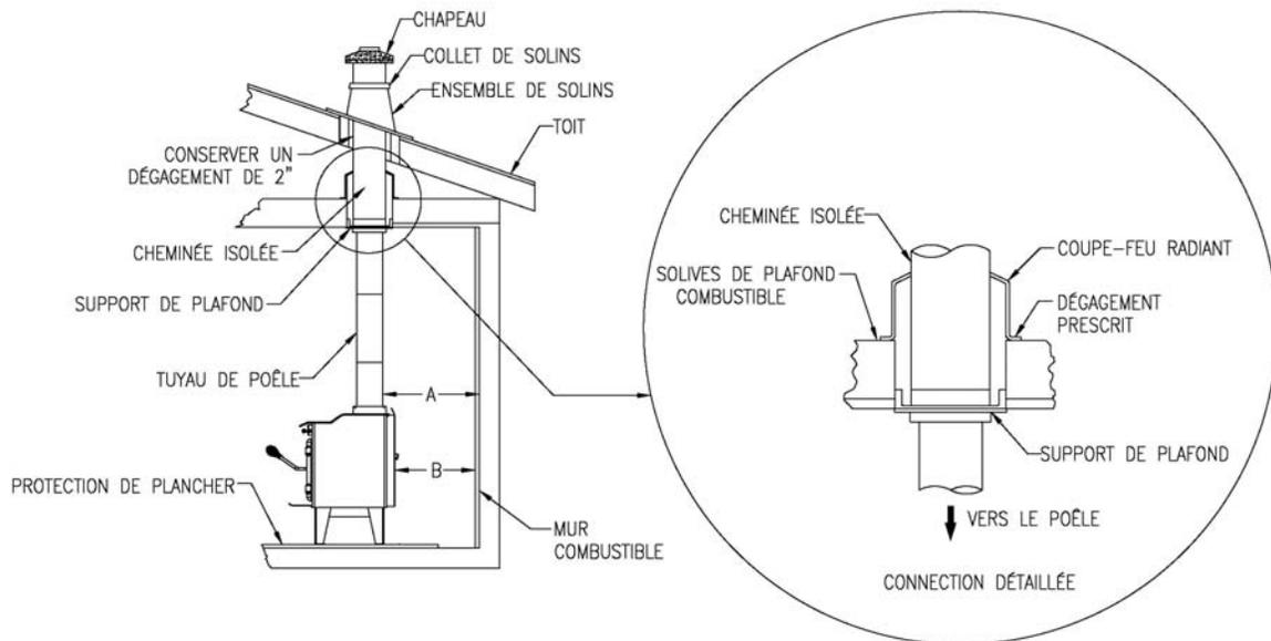
**FIGURE 2.2.1 (B) Installation typique à travers le plafond**
