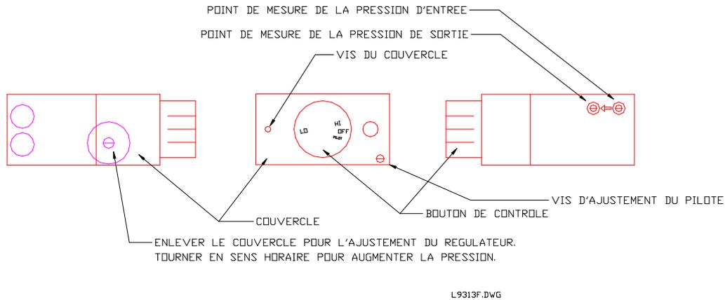
Les pressions se mesurent en dévissant la vis à l'intérieur du point de mesure de 2 ou 3 tours et en plaçant un tuyau flexible de diamètre inférieur d'environ 5/16" (8 mm) directement sur le point de mesure. La pression devrait être :
